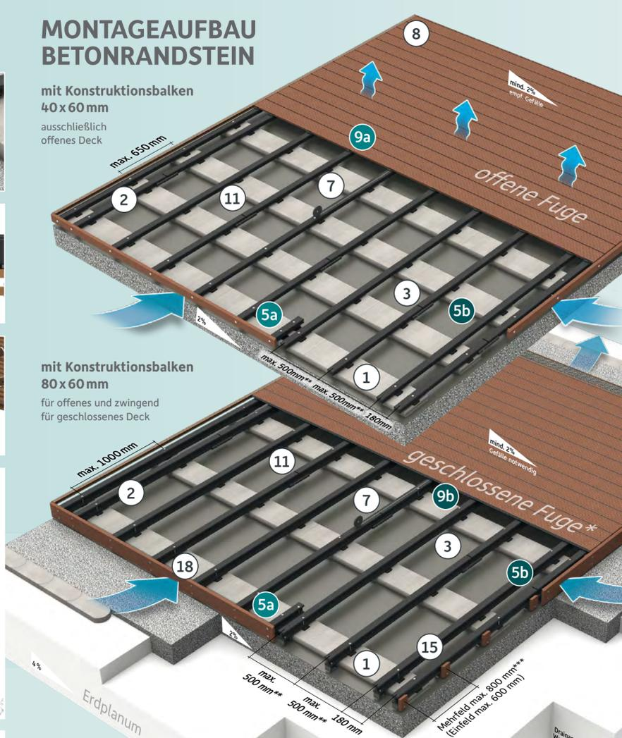
\* ab Aufbauhöhe 161 mm und zwingend mit mindestens 2 % Dielenlängsgefälle! (siehe Aufbauvarianten)
